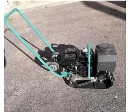
La commune a fait l'acquisition d'une dameuse. C'est une plaque vibrante pour le tassement de l'enrobé à froid pour l'entretien des voiries communales
